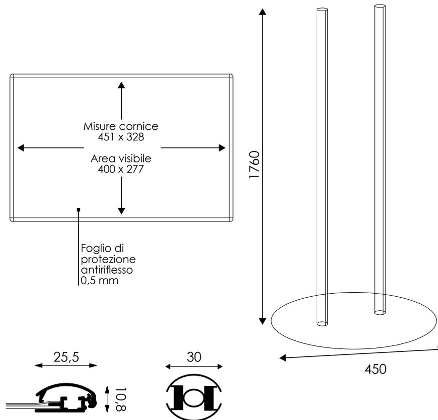
Struttura mono o bifacciale composta da due montanti in alluminio anodizzato silver Ø 30 mm con applicate cornici scatto f.to A3 ad angolo tondo frame 25 mm, complete di fogli di protezione frontale in PVC antiriflesso. Altezza: 1760 mm. Base in metallo verniciato a polveri silver sp. 6 mm Ø 45 mm.
