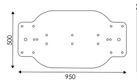
Struttura per interni a linea arcuata realizzata con profili in alluminio e scheletro interno in acciaio. Base e coperchio superiore in metallo verniciato a polveri silver. Superfici espositive in forex bianco 3mm con foglio di protezione in PVC antiriflesso per grafiche intercambiabili. Altezza struttura 2000 mm. Possibilità di inserire uno o più divisori ad altezze richieste per la gestione di grafiche indipendenti tra loro.
